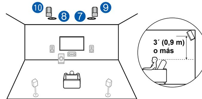
El ancho entre los altavoces altos traseros debe coincidir con el ancho de los altavoces delanteros y deben instalarse a una altura mínima de 3'/0,9 m con respecto a los altavoces delanteros y se inclinan hacia la posición del oyente.
