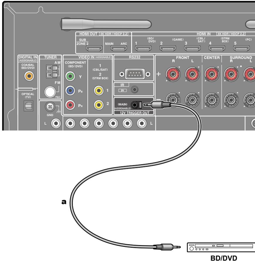
Cuando conecte un dispositivo equipado con un conector TRIGGER IN como un reproductor BD/DVD a esta unidad, el dispositivo se puede encender o poner en espera interbloqueando el funcionamiento de esta unidad. Cuando se selecciona cualquier entrada, esta unidad emite una señal de control de 12 V/100 mA desde el conector 12V TRIGGER OUT y controla el funcionamiento de alimentación enlazada del dispositivo externo.
