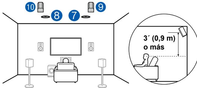
El ancho entre los altavoces altos traseros debe coincidir con el ancho de los altavoces delanteros y deben instalarse a una altura mínima de 3' / 0,9 m con respecto a los altavoces delanteros y se inclinan hacia la posición del oyente.
