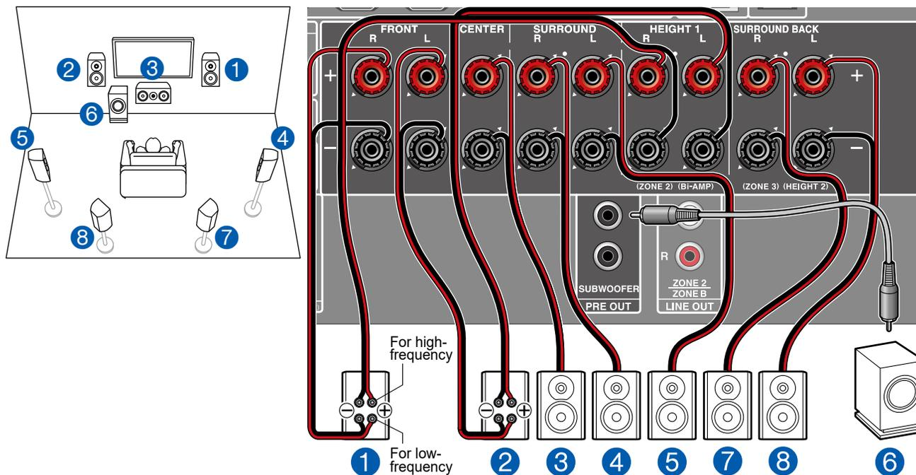
Es posible configurar un sistema de canales 7.1 (→p19) conectando altavoces delanteros que admitan la conexión de biamplicación.
