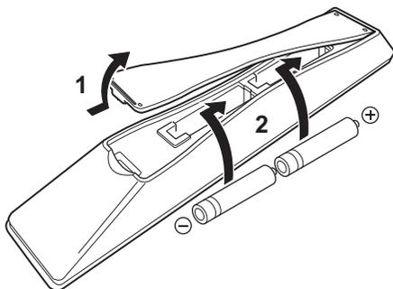
**3** Remplacez le couvercle du logement des piles.
