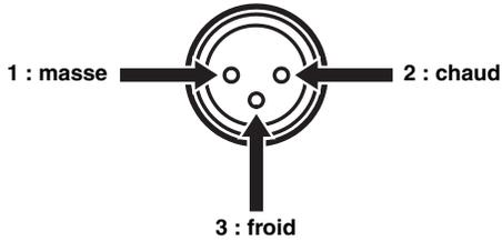
Lors du raccordement, veillez à bien aligner les broches et à insérer la fiche symétrique XLR « femelle ». Pour débrancher le câble à fiche « femelle » symétrique XLR, tirez sur la fiche tout en appuyant sur le taquet.
